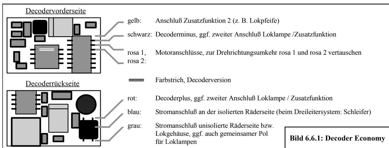
auf maximal **0,5 A** festgelegt. Ein nicht allzu starker H0 Lokmotor verbraucht im Dauerbetrieb bis etwa 0,4 A, sodass für den Anschluss einer Zusatzfunktion noch etwa 0,1 A verbleiben. Der Vorteil dieser Einsparungen liegt aber auch in den etwa 30% geringeren Abmessungen des „Economy“-Decoders. Durch einen kleinen Umbau konnte im Testlabor der Einbau des Decoders in eine H0 Köf-Lok von Piko vorgenommen werden.
