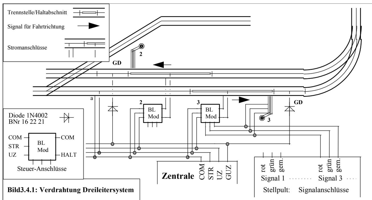
Beim Durchfahren des Abschnittes **GD** erhält der Decoder den Hinweis, dass der nächste Haltabschnitt durchfahren werden kann, solange sich die Fahrtrichtung der Lok nicht ändert. Nach dem Durchfahren sorgt dann die Dateninformation des folgenden Streckenabschnittes **STR** dafür, dass der Hinweis zur Durchfahrt im Decoder wieder gelöscht wird. Deshalb muss zwischen zwei Anhalteabschnitten ein Streckenabschnitt **STR** von mindestens 30 cm Länge liegen.
