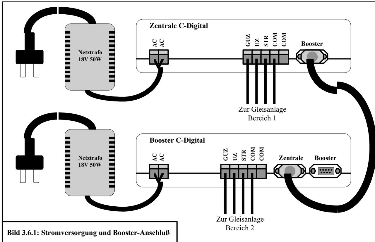
**Bild 3.6.1: Stromversorgung und Booster-Anschluß**
