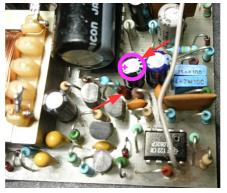
Austausch Kondensator 22uF zu 10uF (rechter Pfeil), Austausch 22K Widerstand zu 33K (linker Pfeil). Am 33K Widerstand oben wird die Steuerleitung ws-gn angelötet.
