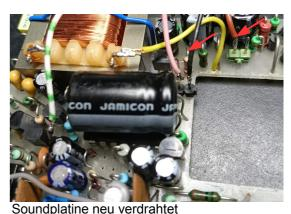
rs: F2 Sound Pfeife, ws-gn: F1 Sound Fahren bn: Decoderminus am Lötstift (roter Pfeil rechts) oder direkt am Wirderstand (roter Pfeil
