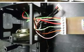
Anschlüsse ins Führerhaus geführt und an der Zusatzplatine eingeklemmt.
