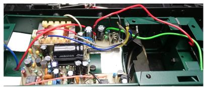
Original-Verkabelung. Links: Motor- und Gleisanschlüsse. Rechts: Verdrahtung der Spitzenlichter zur Soundplatine, vorne weiß-rot und hinten rot-grün. Die Motor und Gleisanschlüsse wurden abgelötet.
