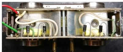
Motor original. Anschlussdrähte rt und gn werden entfernt
