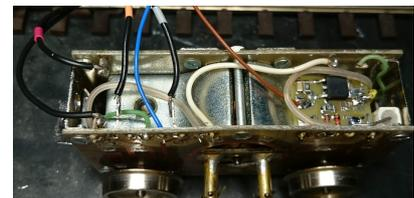
Oben rechts Motorplatine angeschlossen. Unten Verdrahtung Motorteil komplett.
