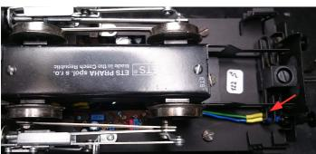
Zusammengebaute Lok mit der herausgeführten Buchse F1 und Decoderplus
