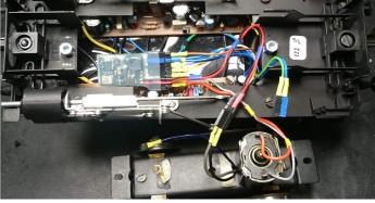
Decodereinbau im vorderen Kesselteil, Motoranschlüsse, Gleisabnahme und F1-Anschluß mit Decoderplus
