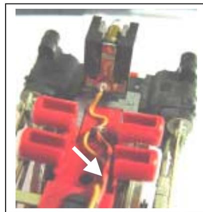
**18) Links:** Als Zusatzfunktion 1 wird eine Führerstandsbeleuchtung eingebaut. Dazu wird ein 15V-Birnenchen mit isolierten Anschlußdrähten direkt am Lokdecoder angelötet. Somit entfallen der rote (Decoderplus) und der grüne (Zusatzfunktion 1) Draht des Decoders.
