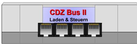
Am Funk-Interface stehen vier Steckbuchsen mit identischen Anschlüssen zur Verfügung. Zum Aufladen der Akkus in den Funkhandreglern dürfen wegen der Strombelastbarkeit der C-Digital Zentrale max. zwei davon gleichzeitig genutzt werden. Außerdem können die Steckbuchsen als Anschluss für Kabel gebundene Handregler verwendet werden.
