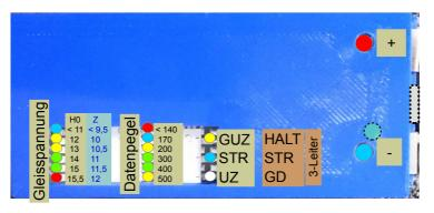
Bei Spur Z Anlagen beträgt die Gleisspannung 10 Volt. Nach Umstellung des Pegelpfüfers auf den Messbereich Spur Z erhalten die LEDs für die Gleisspannung folgende Schwellwerte:
